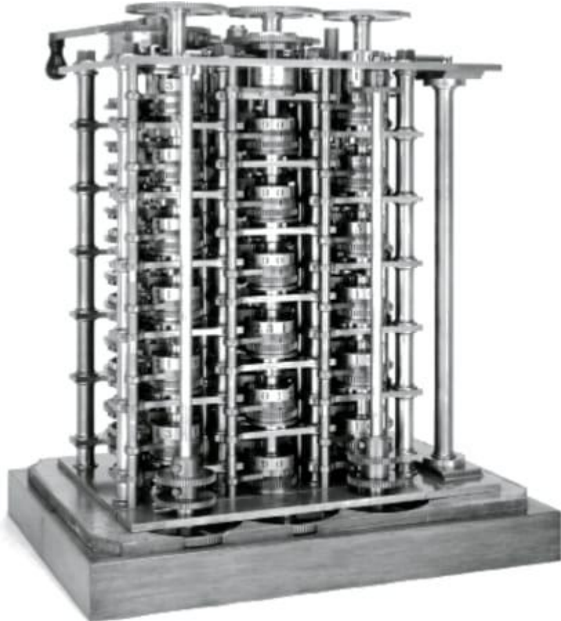
Figura 3. Parte del motor diferencial de Babbage. Crédito: Science Museum / Science & Society Picture Library. —Todos los derechos reservados.
