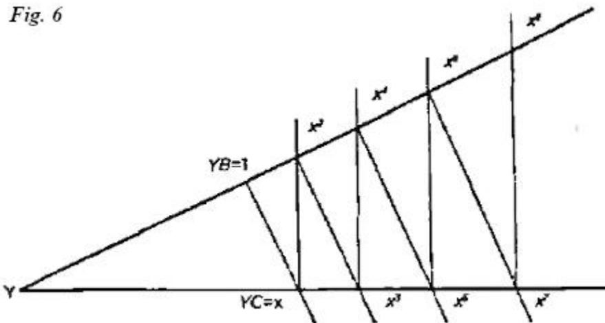
*Sucesivas potencias de un segmento creadas por el mesolabio angular.*
