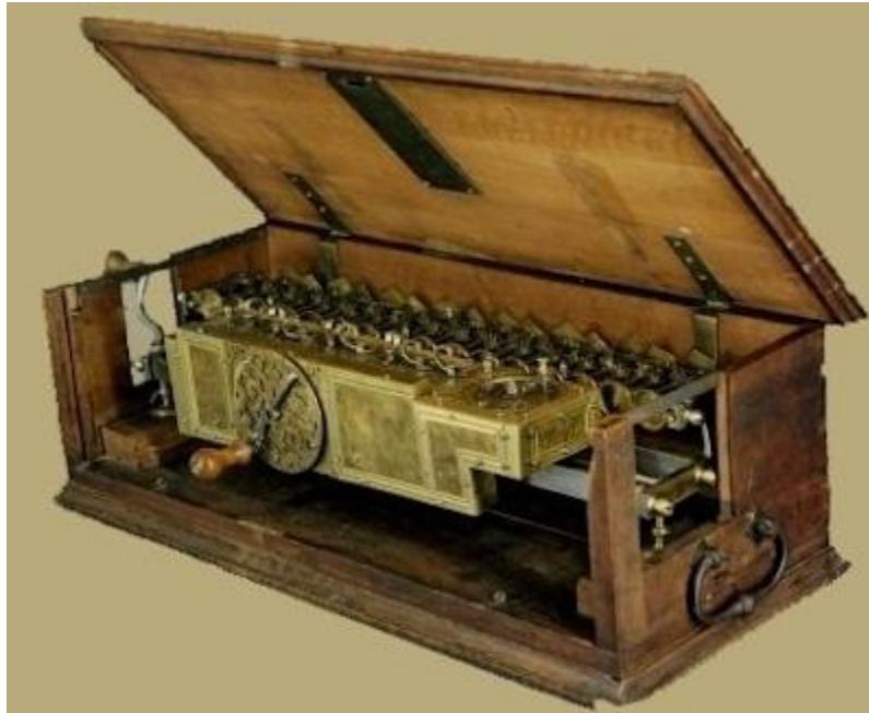
Prototipo de la máquina aritmética inventada por Leibniz. Biblioteca Nacional de la Baja Sajonia, en Hanover.
