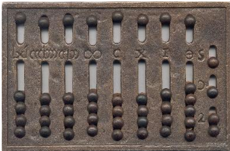
Figura 5. Ilustración de un ábaco romano. Sus columnas representan las unidades, decenas, centenas mediante los símbolos romanos I, X y C. seguidos de unidades, decenas y centenas de millar. Le parte de la derecha se usaba para representar fracciones.
