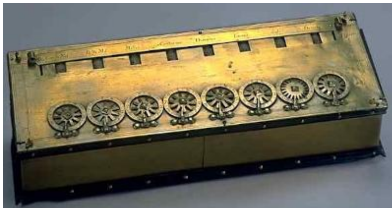
La Pascalina, la máquina de calcular ideada por Pascal
