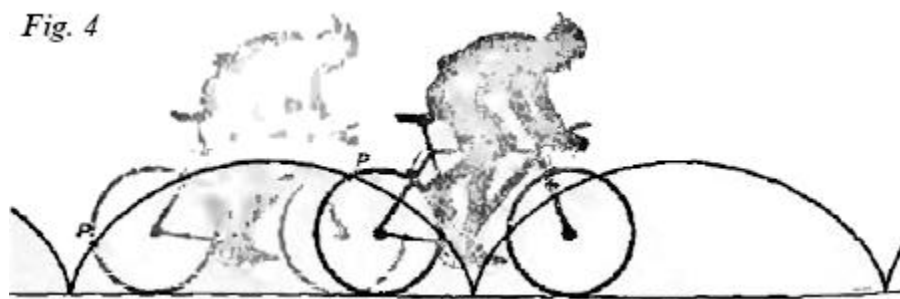
La cicloide como la trayectoria de un punto fijo en una rueda de bicicleta.
