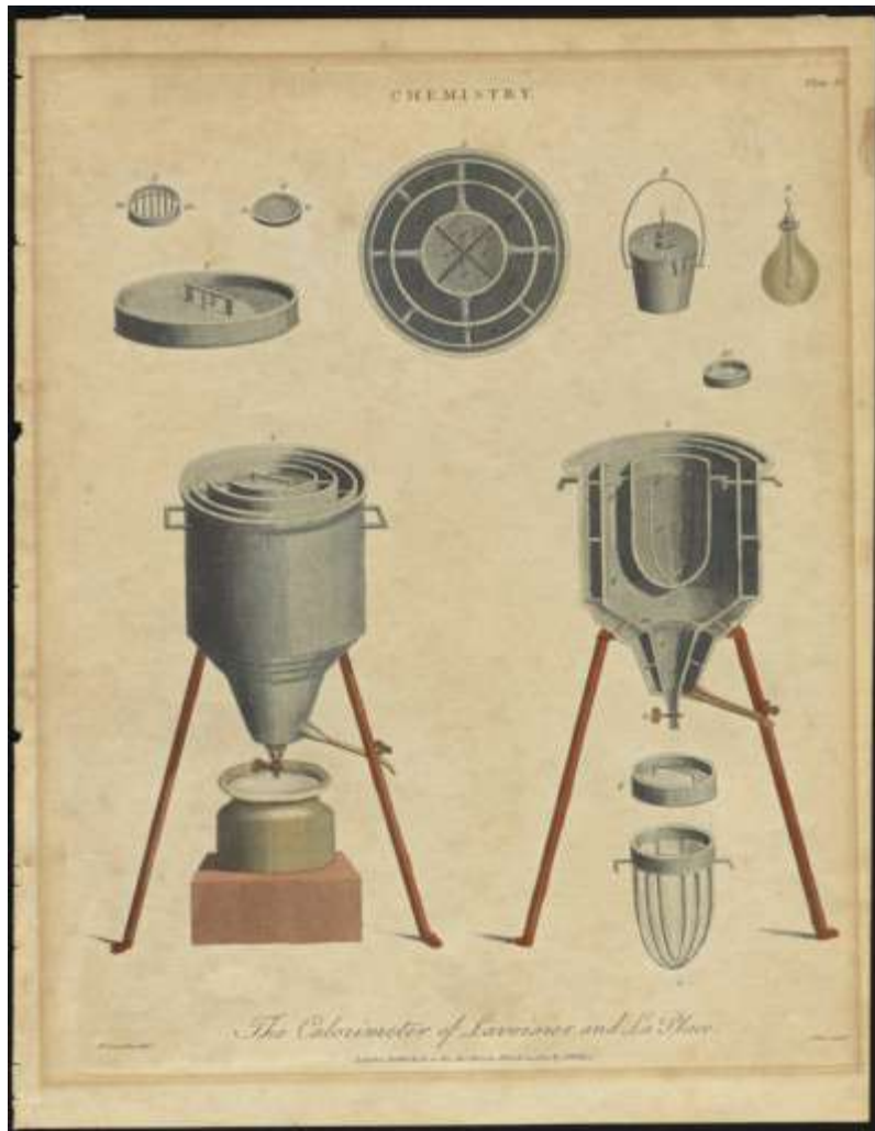
El calorímetro de hielo de Lavoisier y Laplace.
