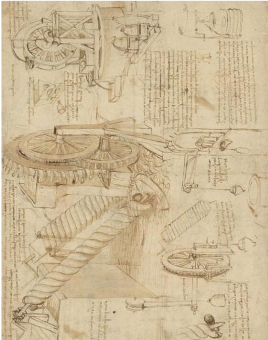
Figura 58. Proyecto para realizar una máquina de movimiento continuo para transportar agua usando el tornillo de Arquímedes.
