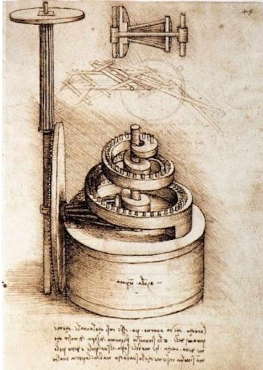
Figura 56. Engranaje en espiral para igualar la velocidad de un resorte
