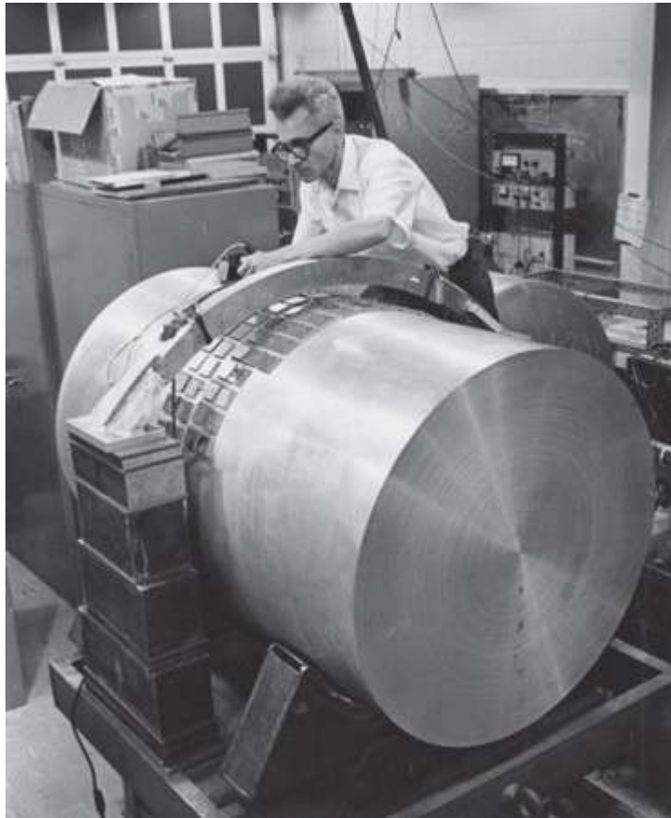
Joseph Weber con su detector de ondas gravitacionales en los años sesenta. Cilindro de aluminio de 150 cm de largo y 95 cm de diámetro. 1660 Hertz. Universidad de Maryland (1969).
