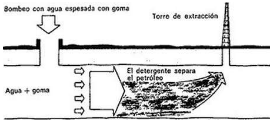
Figura 8-2. Utilización de la goma de xantano para beneficiar petróleo. En primer lugar se bombea hacia el subsuelo agua que contenga algún detergente, para separar el petróleo de las partículas de la roca. Luego se inyecta agua espesada con goma de xantano, que actúa como un pistón y empuja el petróleo hacia la torre de extracción.
