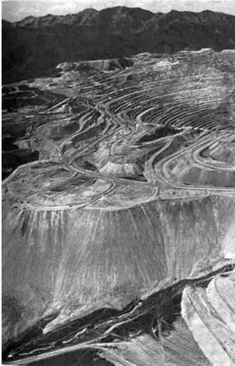
Lámina 14. Operaciones de lixiviación en el exterior de la mina Kennecott's Bingham Canyon, cerca de Salt Lake City, Utah. La mina
