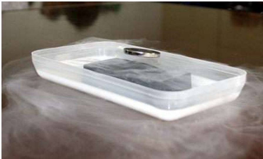
Figura 3 Imán levitando sobre un superconductor. El superconductor utilizado es un óxido de cobre. Se ha enfriado utilizando nitrógeno líquido. Imagen: https://wp.icmm.csic.es/superconductividad/
