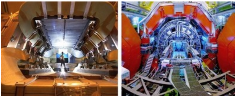
Figura 6. El imán convencional del experimento LHCb, que permite separar materia de anti- materia. Fuente: CERN. Figura 7. El experimento ALICE estudia las colisiones ion-ion. Los detectores se encuentran dentro de un solenoide horizontal. Fuente: CERN.
