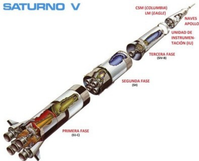
Figura 18. Diagrama del gigantesco cohete Saturno V, obra maestra del ingeniero de origen alemán Wernher von Braun. De 110 metros de altura, fue el mayor jamás construido. Llevó a 27 hombres hasta la Luna sin un solo fallo.
