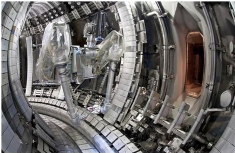
Figura 10. Vista interior del Tokamak europeo JET, donde se está mejorado la pared y el desviador para asemejarlos a ITER. (Foto © iter.org)
