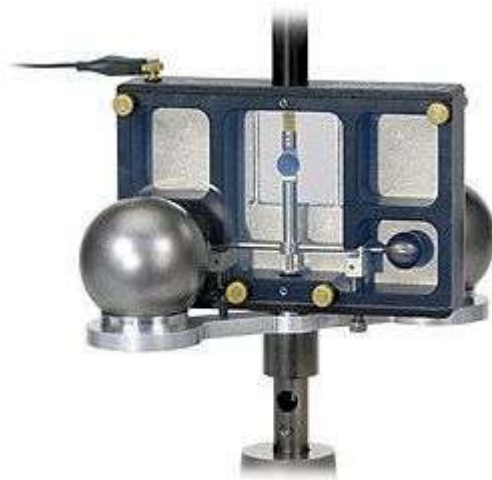
Figura 5.5. Dispositivo comercial para la determinación de la constante de gravitación universal.
