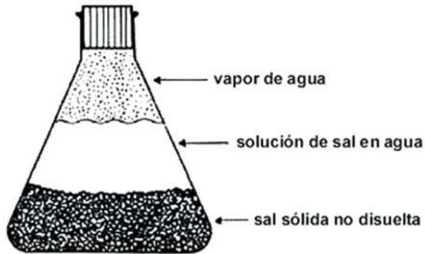
Figura 12. Ejemplo de un sistema heterogéneo formado por sal, solución de sal en agua y vapor de agua.
