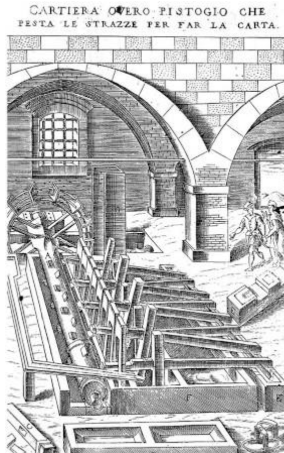
16. La ilustración más antigua conocida de un molino apisonador para preparar pulpa de papel, publicada en Novo Teatro di Machine et Edificii, por Vittorio Zonca, 1607. [Copia facsimilar, colección del autor.]103,7 (43)
