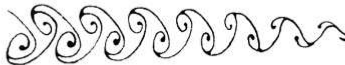
Figura 9. El flujo de un líquido sobre un delgado filamento produce los complicados vórtices aquí representados que recuerdan algunos rasgos superficiales del planeta Júpiter. (Reproducido con el permiso del Dr. David Tritton.)
