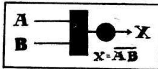
Del esquema se deduce que con las señales que llegan a las entradas A y B se realiza la operación del producto lógico (en el elemento "Y") para a continuación con el producto AB proceder a la negación.
