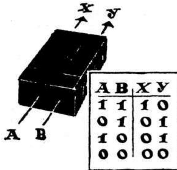
Este cuadro se diferencia del visto anteriormente en que en lugar de una tiene dos columnas para las señales de la salida (X e Y). En esencia, se trata de dos cuadros que responden a dos robots. Uno para la salida X y otro para la salida Y. Ambos dispositivos automáticos tienen comunes las entradas A y B.
