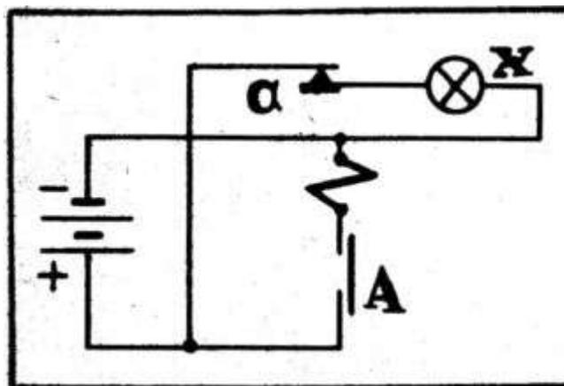
Si se aprieta el botón A (lo que implica dar paso a una proposición cierta a la entrada del elemento), pasará corriente por la bobina del relé, los contactos "a" de este se abrirán y el piloto (X), que estaba luciendo, se apaga, es decir, desaparece la señal a la salida del elemento "NO".
