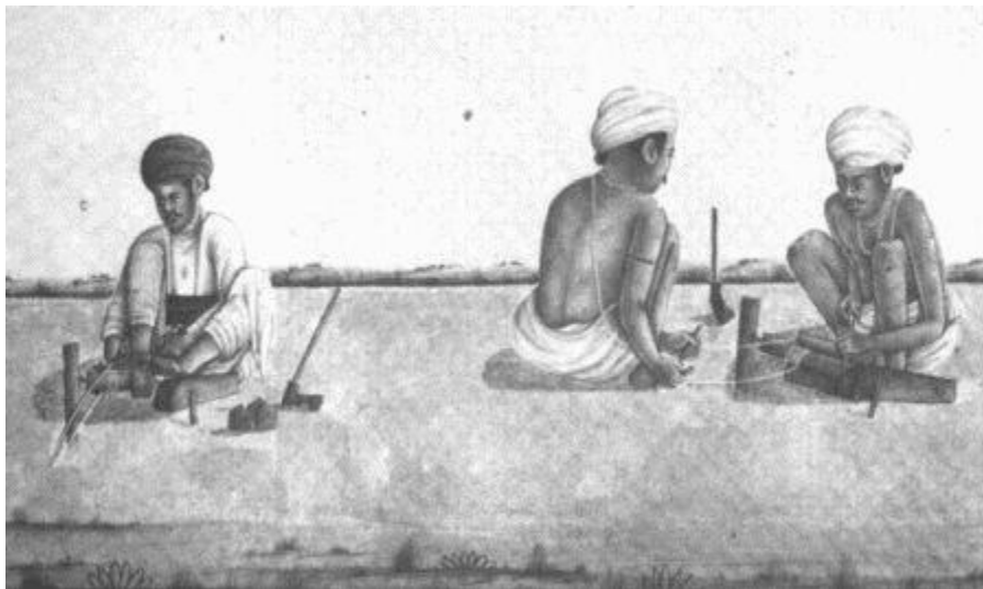
Figura 11. El torno de arco constituye un patrón clásico para convertir el movimiento lineal en rotatorio. Mediados del siglo XIX; carpinteros trabajando con un torno de arco, India central.
