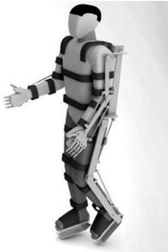
Figura 10. Este es el exoesqueleto que, según el doctor Nicoletis, una persona totalmente parálitica podrá controlar con la mente. (Laboratorio del doctor Miguel Nicoletis, Duke University)
