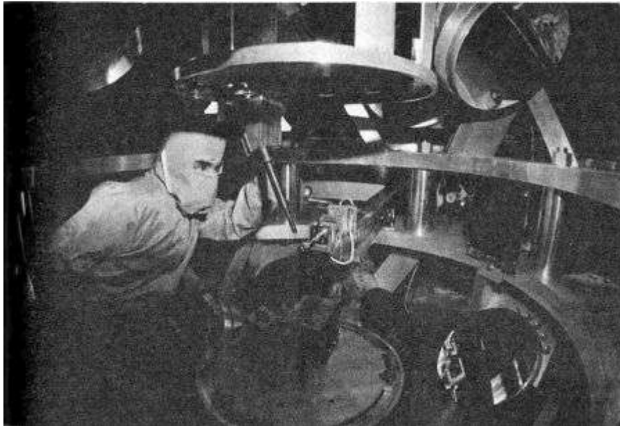
Un operario revisa la cámara del objetivo de Helios, el mayor láser de fusión de dióxido de carbono del mundo. El objetivo sobre el que los ocho haces de Helios convergen se coloca en el centro de dicha cámara. Los Alamos National Laboratory
