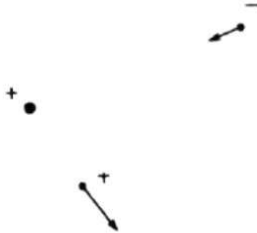
Fig. 1-2. El campo eléctrico. La carga positiva fija está rodeada por un campo eléctrico invisible. Las cargas de prueba captan el campo existente en sus proximidades y se sienten atraídas (—) hacia la carga central o repelidas por ella (+).
