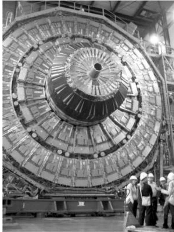
Figura 5.1. Uno de los detectores del LHC (Large Hadron Collider) en el CERN, en Ginebra, durante su montaje. Uno de los aspectos que más impresionan de la física actual es la enorme magnitud de las instalaciones necesarias para estudiar las partículas subatómicas.
