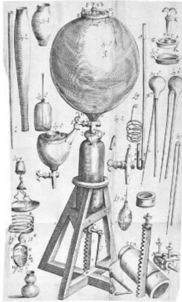
La primera bomba de aire de Boyle, diseñada y construida por Robert Hooke, de New Experiments Physico-mechanical (1660), de Boyle. (© The Royal Society, Londres).
