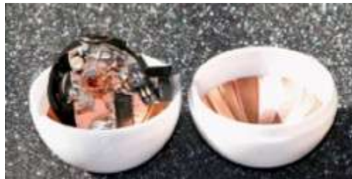
Una de las «pelotas de ping-pong» equipadas con un radiotransmisor que se introdujeron en el tubo del haz del LHC para comprobar si había alguna obstrucción. LYN EVANS
