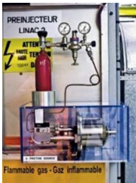
Todos los protones del haz del LHC provienen de esta pequeña bombona de hidrógeno, que contiene protones suficientes para alimentar al LHC durante mil millones de años. © CERN
