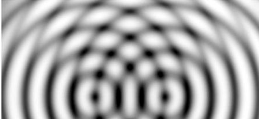
Figura 8.3. Cuando se solapan dos ondas de agua, ellas «interfieren», lo que crea regiones alternas de mayor o menor agitación que forman lo que se denomina una figura de interferencia.
