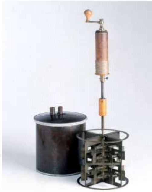
Aparato ideado por James Prescott Joule para medir la equivalencia entre calor y trabajo.
