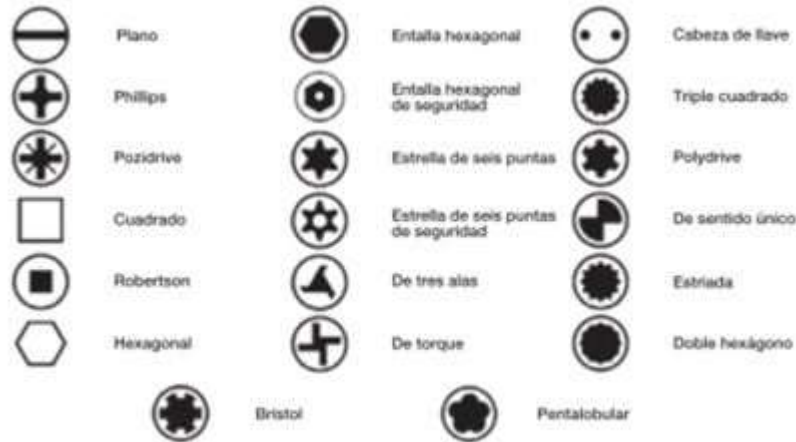
Cabezas de destornillador: un ejemplo cotidiano de diversidad en el diseño.
