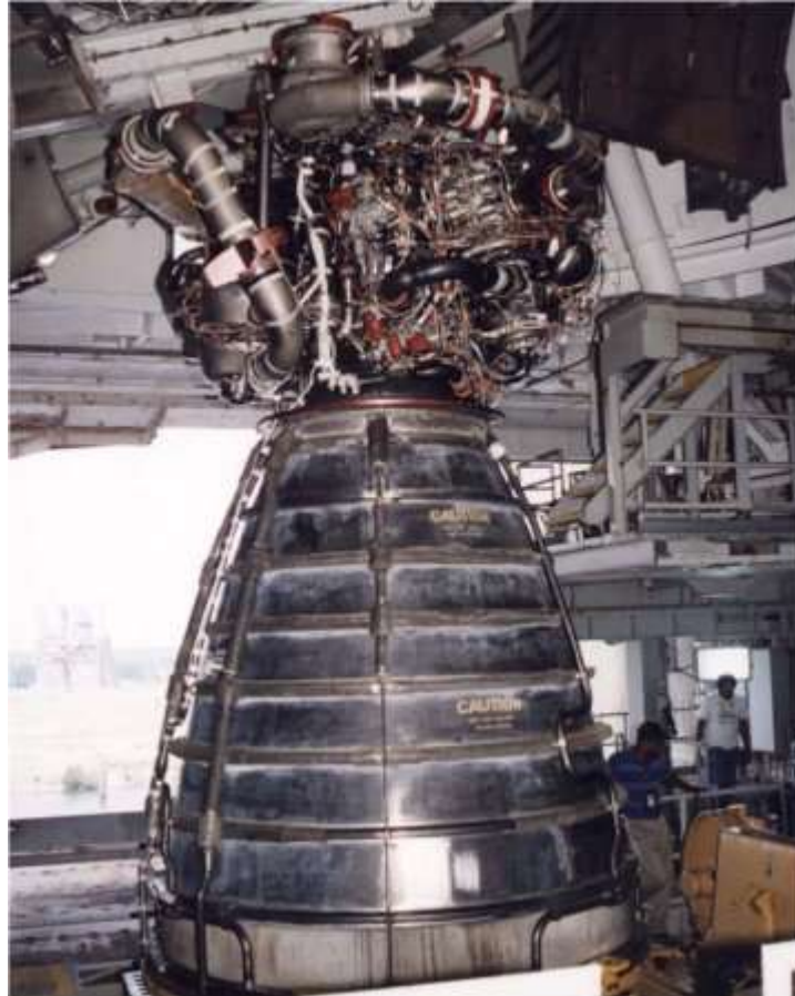
Motor SSME del transbordador espacial, un motor de combustión escalonada. (Foto: NASA)
