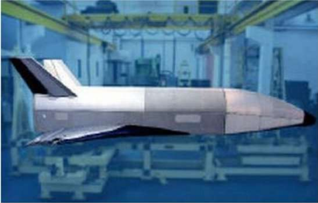
Maqueta para túnel de viento del RLV-TD, un vehículo demostrador para investigación tecnológica que abrirá camino al Avatar. (Foto: ISRO)
